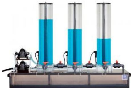
Le système à trois réservoirs se compose de trois cylindres en plexiglas interconnectés en série par des vannes à commande manuelle.
