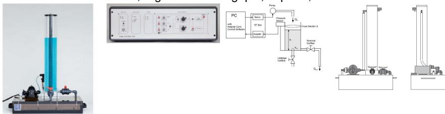
Le système à 1 réservoir se compose d'un cylindre réservoir et une pompe montés sur un bac de rétention rectangulaire.
