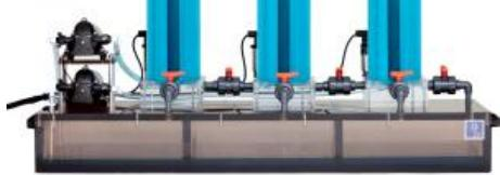
Le système à trois réservoirs se compose de trois cylindres en plexiglas interconnectés en série par des vannes à commande manuelle.
