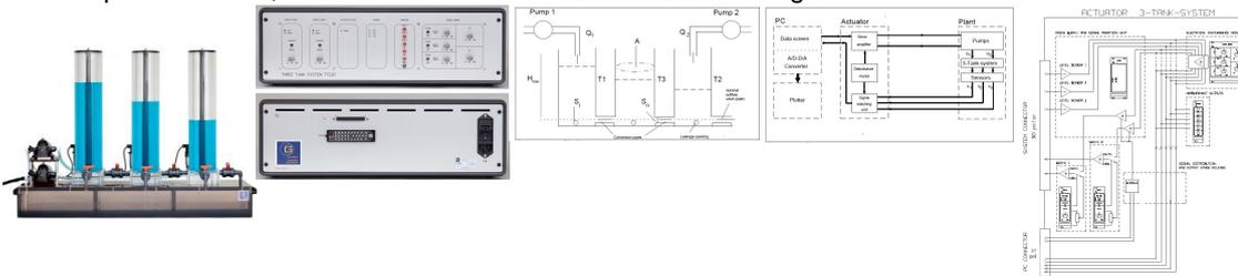
Le système à trois réservoirs se compose de trois cylindres en plexiglas interconnectés en série par des vannes à commande manuelle.
