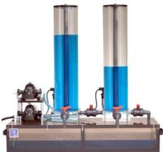
L'expérience de laboratoire "Système à 2 réservoirs DTS22" inclut la réalisation technique d'un système multivariable non linéaire (deux entrées deux Variables de sortie) avec deux actionneurs et un contrôleur numérique (Régulation non linéaire et découplage).
