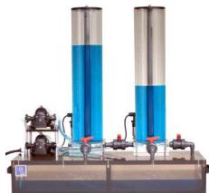
L'expérience de laboratoire "Système à 2 réservoirs DTS22" inclus la réalisation technique d'un système multivariable non linéaire (deux entrées deux Variables de sortie) avec deux actionneurs et un contrôleur numérique (Régulation non linéaire et découplage).
