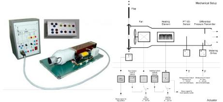
Le dispositif expérimental de laboratoire "Régulation de débit et de la température de l'air" comprends 2 systèmes (Premier ordre pour la régulation de débit, régulation de température d'un ordre supérieur).
