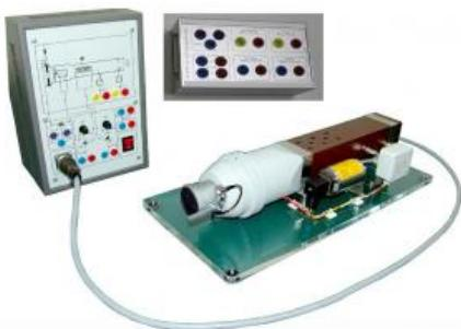
ATC71 Système de régulation débit d'air et température entrées et sorties en 4...20 mA et 0...10 V
