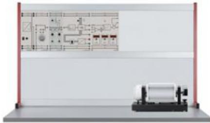
Les expériences sont mises en place avec des plaques expérimentales dans un cadre profilé. Le Profi-CASSY est utilisé pour contrôler ce système technique ainsi que pour enregistrer et évaluer les valeurs mesurées.
