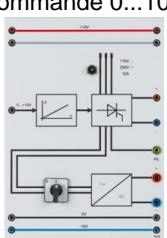
Pour raccorder des moteurs à courant continu de 0,1 kW à 1,0 kW alimentés par le réseau.
