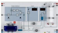
C'est un système de régulation compact pour des expériences de régulation de débit et de niveau.
