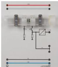
L'anémomètre permet la mesure mécanique de la vitesse moyenne d'un gaz par la rotation du moulinet qui est saisie par un capteur optique.
