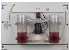
Il sert de modèle de navire porte-conteneurs pour l'étude des phénomènes d'instabilité d'un système non-linéaire, par ex. régulation de la position horizontal d'un navire.
