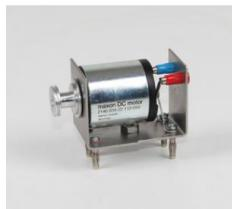
Moteur à courant continu à rotor sans fer à faible inertie, avec un tambour à câble et poulie à filetage fixés sur l'arbre du moteur.
