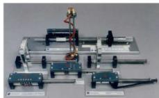
Le Kit transducteurs électromécaniques TK2941E est composé de six transducteurs de déplacement linéaire. C'est le kit de base pour la gamme TK2942 et introduit quelques principes de base sur les transducteurs et les exigences d'instrumentation associées.
