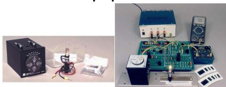
Le kit Transducteur de lumière TK2841L contient un dispositif de détection optique, trois dispositifs photoélectriques et une sélection de filtres optiques.
