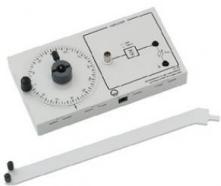
Cet appareil sert de socle pour les antennes dipôles, Yagi et helicoidal lors du relevé de diagrammes de directivité. La position angulaire de l'antenne est définie manuellement et peut être relevée sur un disque tournant pourvue d'une échelle angulaire. Le signal de l'antenne testée est reçu et amplifié par un amplificateur sélectif en fréquence qui l'amène à un niveau facile à exploiter.
