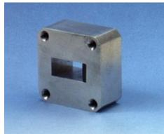
Les atténuateurs fixes servent à réduire d'une valeur fixe les puissances hyperfréquence. Ils sont utilisés pour la protection d'éléments sensibles ou pour le découplage de parties du montage. Le dispositif employé pour réduire la puissance est un atténuateur intégré en matériau absorbant. Constitution: Module en aluminium
