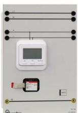
L'affichage LCD, en liaison avec le coupleur de bus, sert à indiquer 8 états de commutation ou des variables physiques (comme par exemple l'indication de défaut, ou la température), transmis à l'ABB I-bus EIB. Un certain état peut être modifié, et peut par conséquent être influencé, par exemple, la valeur d'essai de la température ambiante.
