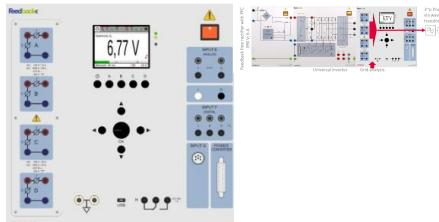
Le Power Control CASSY est l'appareil de commande universel pour la technique énergétique.
