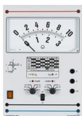
Instrument de démonstration pour mesurer la puissance active, la puissance réactive capacitive et inductive dans une plage de 0,3 W (var) à 30 kW (kvar).
