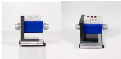
Moteur synchrone autopiloté tétrapolaire à aimantation permanente (sans balais), utilisable comme entraînement direct ainsi que pour la réalisation d'un asservissement de position ou d'un entraînement régulé hautement dynamique fonctionnant dans les quatre quadrants.
