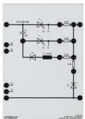
Thyristor avec circuit d'extinction par condensateur et avec bras de roue libre.
