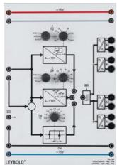
Appareil de commande universel pour la réalisation de hacheurs à commutation, d'alimentations à découpage et d'onduleurs autonomes monophasés.
