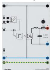
Alimentation réglable fournissant une tension et un courant lissés pour l'excitation d'un alternateur synchrone des gammes de puissance 0,3 kW ou 1,0 kW.
