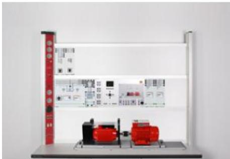
Les essais sont réalisés avec des machines de classe 1 kW IE3 fabriquées industriellement.
