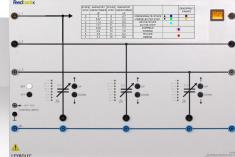
Charge capacitive triphasée, robuste et à usage universel, avec une puissance absorbée réglable jusqu'à 1 kvar.
