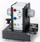
Sert à mesurer la vitesse de rotation des machines électriques des gammes 0,1 et 0,3 kW.
