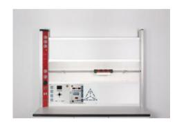
Des expériences sur les principes de fonctionnement des moteurs linéaires sont réalisées à l'aide des composants du système de machines électriques d'apprentissage, alimentées en basse tension de protection. Les machines didactiques sont montées sur une unité de base claire, disposée verticalement dans le cadre d'expérimentation.
