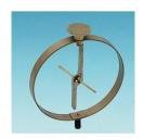
Pour des expériences de base et d'initiation à l'électrostatique ainsi que pour l'affichage de tensions continues et alternatives. Sert aussi à illustrer le fonctionnement d'un voltmètre haute tension de Braun. Convient pour la projection d'ombres. Livré avec une plaque de condensateur et deux douilles d'adaptation au silicium.
