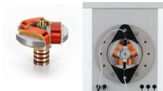
Sur noyaux de fer en paquets de toles feuilletées sans courant parasite ; avec coussinet de pivotement, poulie et tambour d'enroulement.
