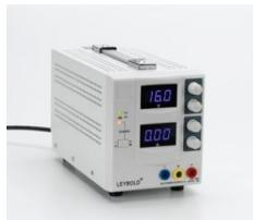
Alimentation CC, comme source de tension constante avec limitation de courant et comme source de courant constant avec limitation de tension, permet un fonctionnement en parallèle et en série de plusieurs appareils. Convient très bien pour les travaux pratiques avec des élèves de tous âges grâce à l'isolation sécurisée conformément à la réglementation BG/GUV-SI 8040.
