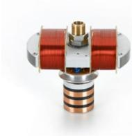
Sur noyaux de fer en paquets de tôles feuilletées sans courant parasite ; avec coussinet de pivotement, poulie et tambour d'enroulement.
