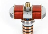
Sur noyaux de fer en paquets de tôles feuilletées sans courant parasite ; avec coussinet de pivotement, poulie et tambour d'enroulement.
