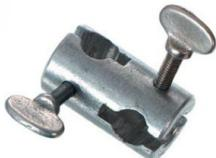
Pour assembler des tiges et des tubes.
