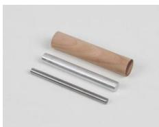
Éléments cylindriques en différents matériaux pour des expériences sur la masse volumique.
