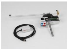
Pour étudier la force radiale d'un corps tournant avec CASSY ( 524013 , 524018 , 524006 , 524005W ) ou l'instrument de mesure universel Physique ( 531835 ) en fonction de sa masse, du rayon de sa trajectoire et de sa vitesse angulaire.
