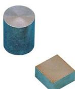
Pour des expériences sur la masse volumique et la capacité calorifique de différents matériaux.
