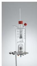
Pour la mesure de l'enthalpie de réaction lors de la combustion de substances solides et liquides.
