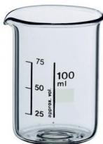
Forme basse, avec bec verseur, ISO 3819, DIN 12331
