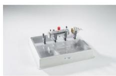
Pour la réalisation d'expériences avec le rayonnement infrarouge (rayonnement thermique), tout particulièrement sur l'absorption du rayonnement IR par le gaz carbonique et les autres gaz à titre de comparaison (effet de serre). Le kit se compose d'un émetteur IR, d'une cuve de mesure réfléchissante et d'un support pour la pile thermoélectrique de Moll.
