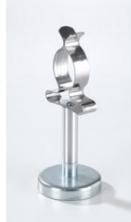
Pince à ressort fixée sur un aimant. Pour la réalisation de montages expérimentaux en chimie sur les tableaux magnétiques ( 666 4659 et 666 4660 ). Peut être utilisé avec tous les modules CPS. Maintient des éléments de 30 à 32 mm de diamètre, par ex. des seringues à gaz et les raccords GL 35.
