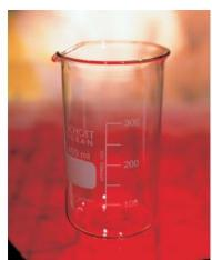
Forme haute, gradué et avec bec verseur, DIN 12 331, ISO 3819
