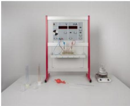
Une différence de potentiel peut être mesurée dans une cellule galvanique constituée de demi-piles identiques avec une température différente.
