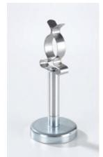
Pince à ressort fixée sur un aimant. Pour la réalisation de montages expérimentaux en chimie sur les tableaux magnétiques ( 666 4659 et 666 4660 ). Peut être utilisé avec tous les modules CPS. Maintient des éléments de 27 à 29 mm de diamètre, par ex. les raccords RN 29 et GL 32.
