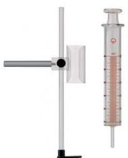
Pour mesurer et prélever un volume de gaz défini. Le corps cylindrique est gradué tous les 1 ml. Le verre SVL (à rodage de précision) garantit une parfaite étanchéité avec une grande souplesse de déplacement du piston ainsi qu'un ajustage parfait des éléments entre eux.
