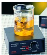
Agitateur magnétique non chauffant, très maniable et peu encombrant pour le laboratoire, livré avec un turbulent. Agitateur à boîtier en plastique avec une capacité d'agitation pouvant être de un litre.
