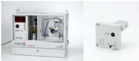
L'expérience C3.6.5.2 permet l'analyse quantitative de la composition d'un alliage de laiton.
