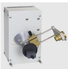
Avec deux moteurs pas à pas qu'il est possible de commander indépendamment l'un de l'autre pour le bras de capteur et le bras de cible. Le déplacement est défini par des boutons-poussoirs de la zone de commande de l'appareil à rayons X ( 554 800 et 554 801 ) et déclenché manuellement ou automatiquement. Inclus au matériel livré avec l'appareil à rayons X ( 554 801 ).
