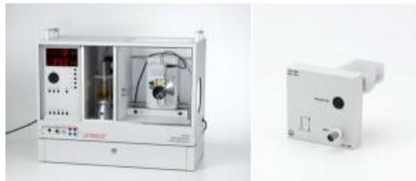
Dans l'expérience C3.6.5.1, on analyse quatre alliages par fluorescence X et on en évalue qualitativement la composition.
