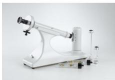
Pour la détermination de la concentration de solutions optiquement actives.
