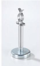
Pince à ressort fixée sur un aimant. Pour la réalisation de montages expérimentaux en chimie sur les tableaux magnétiques ( 666 4659 et 666 4660 ). Peut être utilisé avec tous les modules CPS. Maintient des éléments de 18 à 22 mm de diamètre, par ex. les raccords RN 19 et GL 25.
