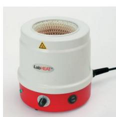
Boîtier revêtu plastique à échauffement minimal grâce à une bonne isolation par tissu en fibres de verre.
