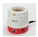
Boîtier revêtu plastique à échauffement minimal grâce à une bonne isolation par tissu en fibres de verre. Régulation en continu de la zone de chauffe par variateur de puissance intégré.
