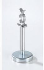
Pince à ressort fixée sur un aimant. Pour la réalisation de montages expérimentaux en chimie sur les tableaux magnétiques ( 666 4659 et 666 4660 ). Peut être utilisé avec tous les modules CPS. Maintient des éléments de 18 à 22 mm de diamètre, par ex. les raccords RN 19 et GL 25.
