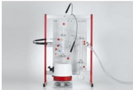
Dans un premier temps, le pétrole est séparé en différentes fractions par distillation fractionnée. Ce faisant, il n'est pas possible d'isoler des substances individuelles étant donné que les points d'ébullition sont très proches les uns des autres.
