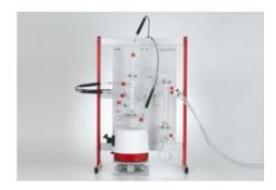
C2.3.2.1 Distillation fractionnée du pétrole avec une colonne à plateaux
