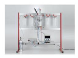
Dans l'expérience C2.3.1.3., on détermine le pouvoir calorifique supérieur du fuel à l'aide d'un calorimètre de démonstration.
