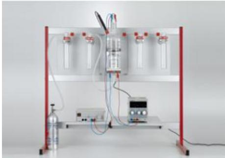
Dans l'expérience C2.3.1.1, on brûle du charbon et on détermine le pouvoir calorifique supérieur à l'aide d'un calorimètre.
