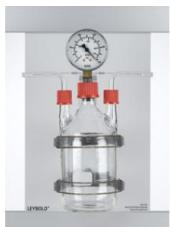
Avec manomètre à ressort livré avec des espaces, du matériel de fixation et des raccords. Convient pour les expériences suivantes
