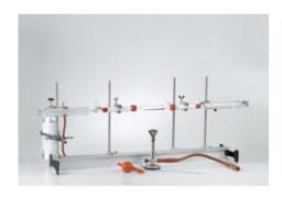
Dans l'expérience C2.1.1.2, on détermine quantitativement la teneur en hydrogène d'un composé organique. On effectue également une analyse par combustion, au cours de laquelle le carbone est transformé en CO2 et l'hydrogène en H2O.
