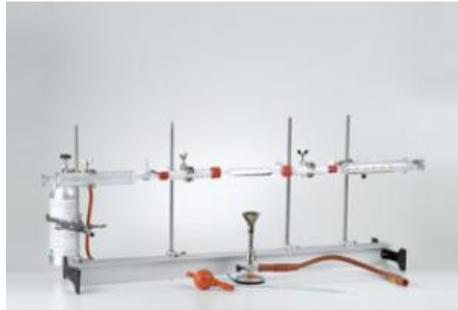
Dans l'expérience C2.1.1.2, on détermine quantitativement la teneur en hydrogène d'un composé organique. On effectue également une analyse par combustion, au cours de laquelle le carbone est transformé en CO<sub>2</sub> et l'hydrogène en H<sub>2</sub>O.
