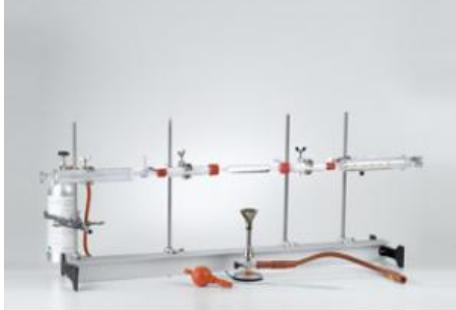
Dans l'expérience C2.1.1.1, on détermine quantitativement la teneur en carbone d'un composé organique. Au cours d'une analyse par combustion, la substance est passée à env. 800 °C - 900 °C sur de l'oxyde de cuivre(II) incandescent.
