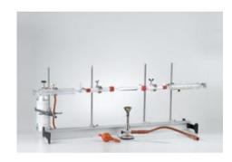
Dans l'expérience C2.1.1.1, on détermine quantitativement la teneur en carbone d'un composé organique. Au cours d'une analyse par combustion, la substance est passée à env. 800 °C - 900 °C sur de l'oxyde de cuivre(II) incandescent.
