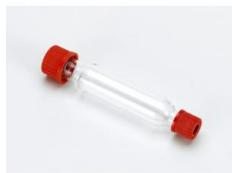
À remplir de granules de CaCl<sub>2</sub> pour la combustion du butane.
